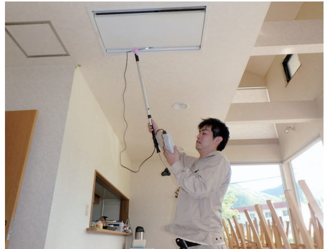
定期報告（検査）で換気設備の風量測定
